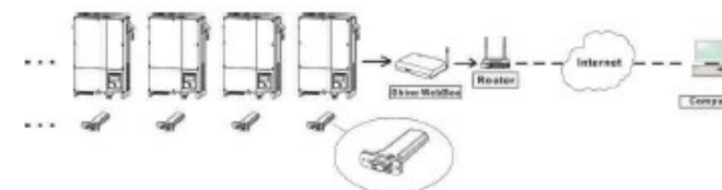
Połączenie interfejsu RS232 z bezprzewodowym rejestratorem danych i Internetem.
